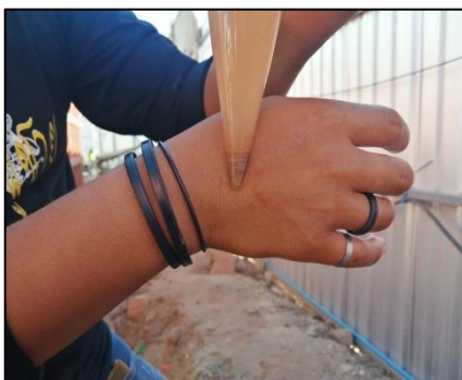
การทดสอบค่า Maximum Sand Content
