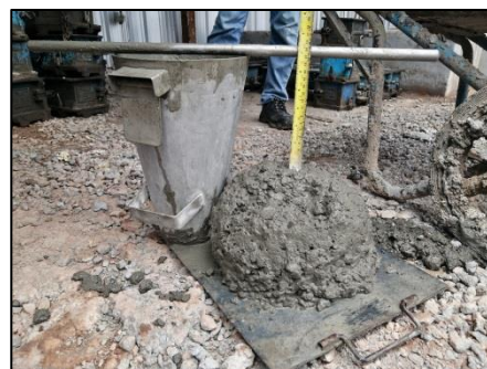
การตรวจสอบค่ายุบตัวของคอนกรีต (Slump Test) ก่อนนำคอนกรีตเทลงในหลุมเจาะ
