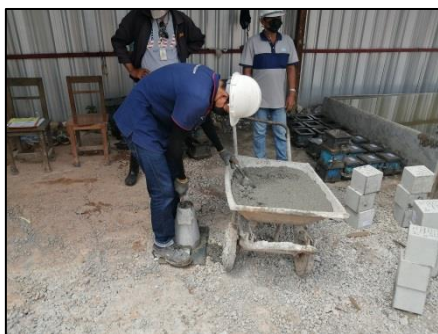
การตรวจสอบค่ายุบตัวของคอนกรีต (Slump Test) ก่อนนำคอนกรีตเทลงในหลุมเจาะ
