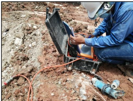
ทำการตั้งค่าเครื่องบันทึกสัญญาณ
