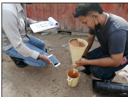
การทดสอบค่า Viscosity โดยการจับเวลา
